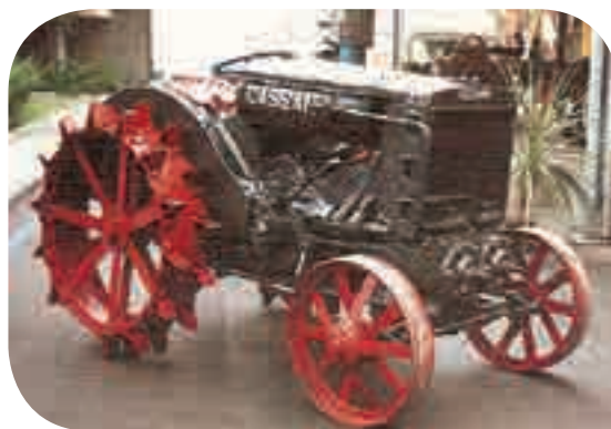
Trattrice Cassani 40 HP con motore diesel a due tempi.
